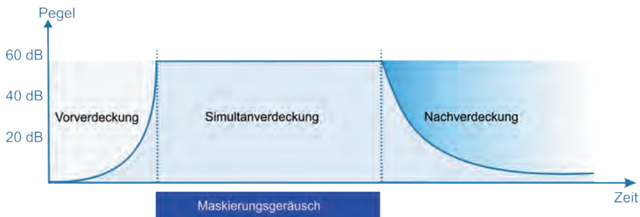
Abb. 4.13: Vor-, Simultan- und Nachverdeckung durch eine Maskierungsgeräusch. Ein Maskierungsgeräusch kann nicht nur einen Ton verdecken, während es präsent ist, sondern auch einen Ton, der sehr kurze Zeit vorher präsentiert wird oder auch einige Millisekunden nach Beendigung des Maskierungsgeräusches.
